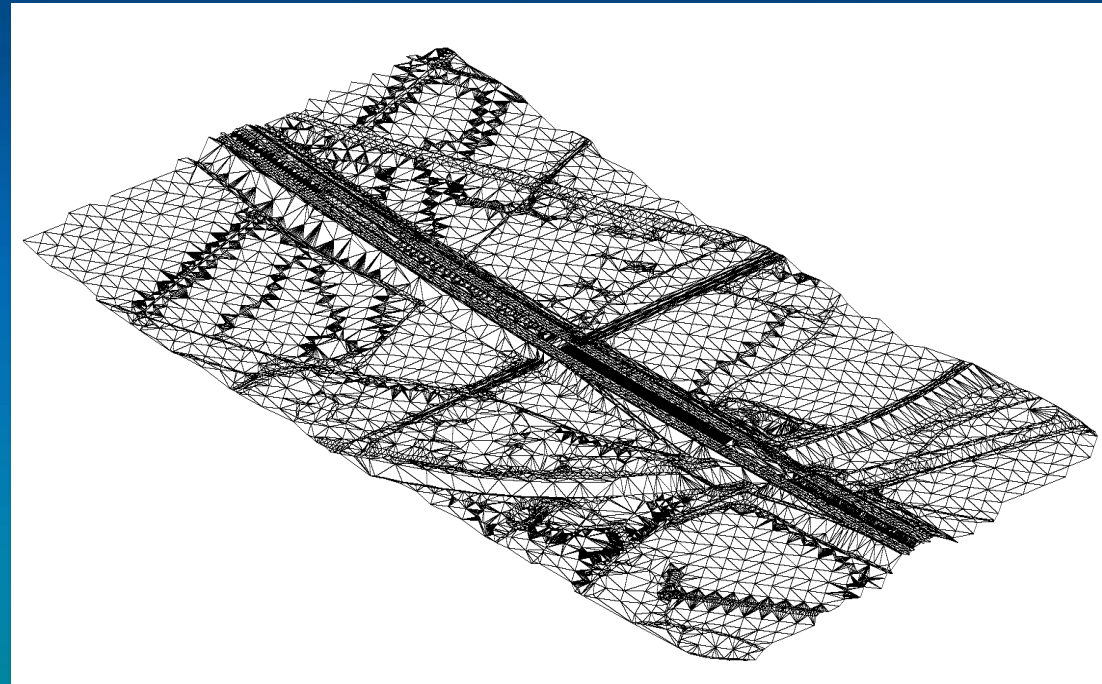
Aus Vermessungsdaten generiertes TIN-Höhenmodell
